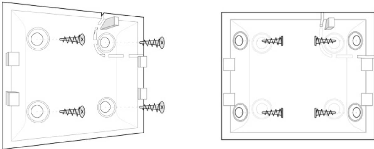
1. Befestigen Sie die SmartBracket-Platte mit Hilfe von mitgelieferten Schrauben an der Oberfläche, wobei Sie mindestens zwei Befestigungspunkte (einen davon – über dem Manipulationsschutz) verwenden müssen. Nachdem Sie andere Befestigungsschrauben ausgewählt haben, stellen Sie sicher, dass sie die Platte nicht beschädigen oder verformen.
